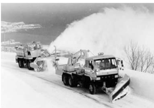
除雪車による除雪作業
